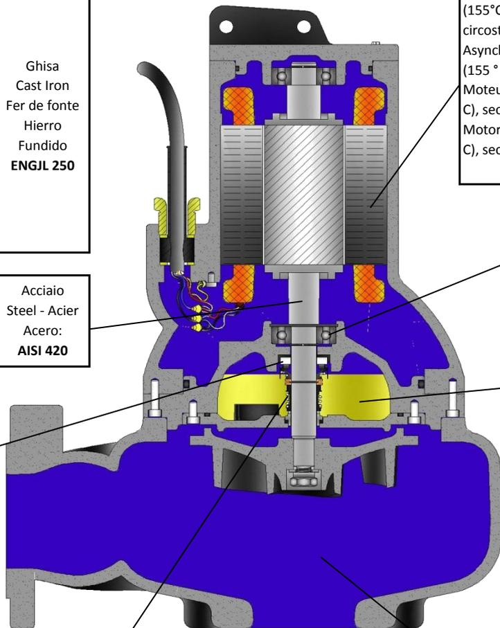
Motore asincrono in classe di isolamento F (155°C), a secco e raffreddato dal liquido circostante
